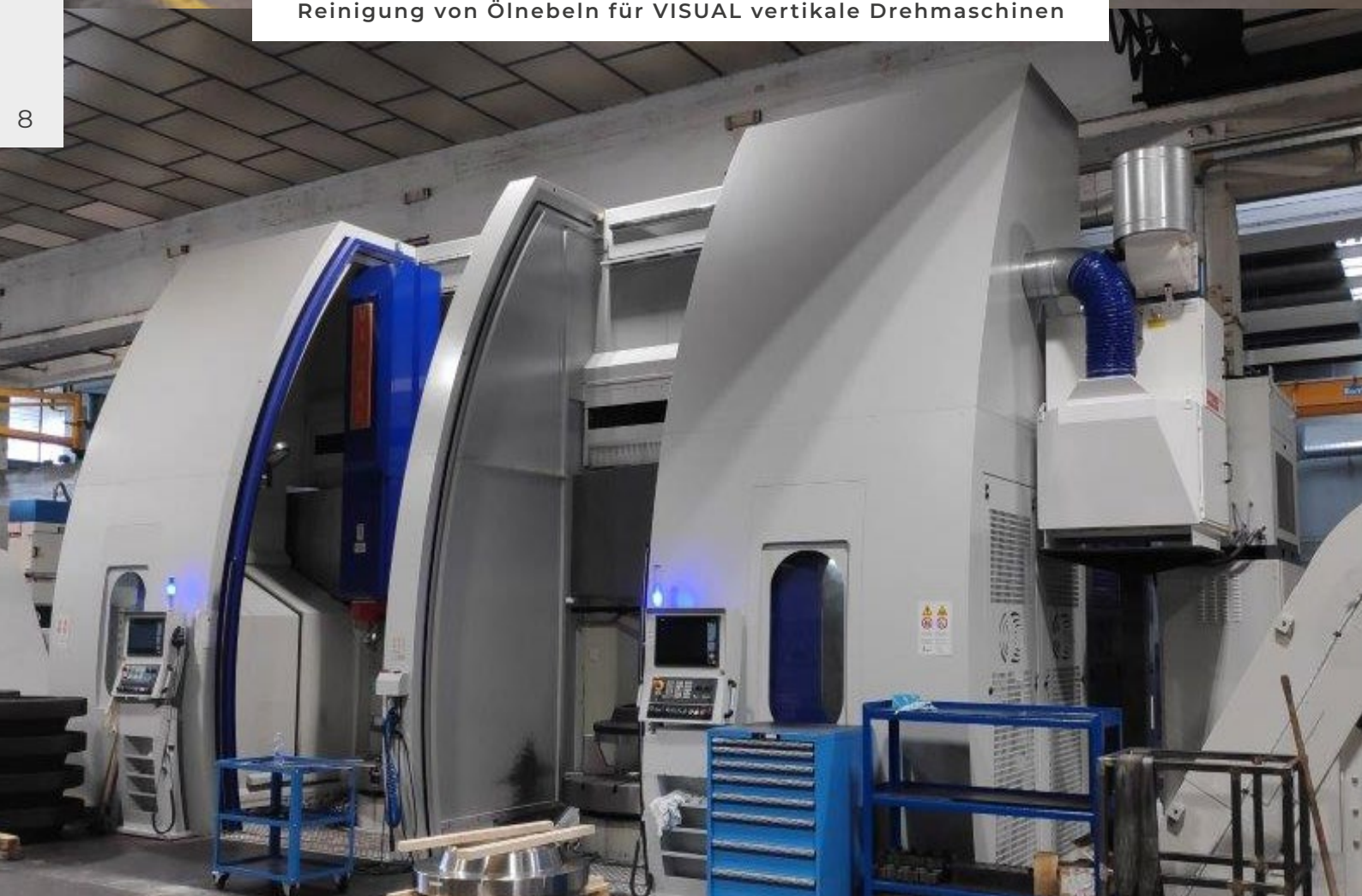
Reinigung von Ölnebeln für VISUAL vertikale Drehmaschinen
