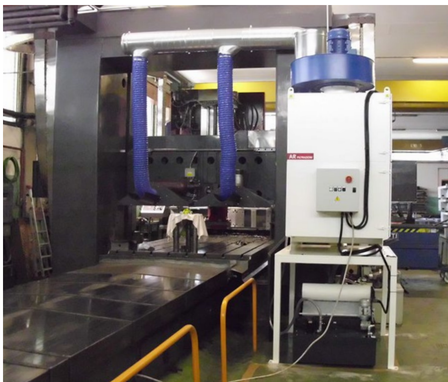
Installation SERIE ARIS auf Fräs-Bohrmaschine
